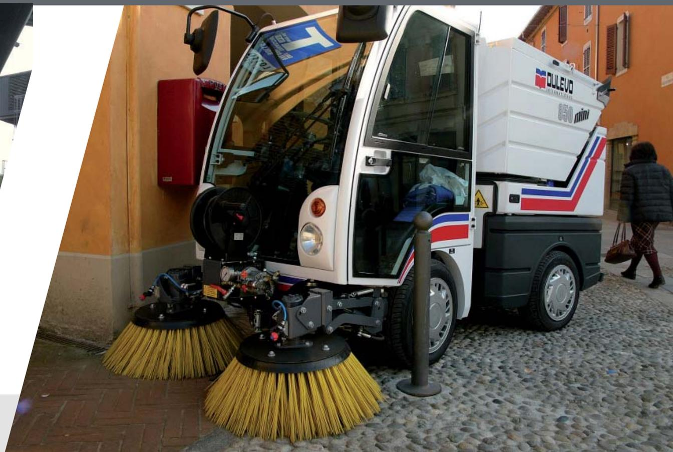
La barredora Dulevo 850 MINI posee la extraordinaria capacidad de subir y bajar fácilmente cualquier acera gracias a sus neumáticos de gran tamaño; el viraje mediante la articulación central de sus dos semibastidores, accionado por medio de una dirección hidráulica y dos cilindros, permite una perfecta manejabilidad especialmente en las curvas, bordeando uniformemente las aceras durante la limpieza sin el riesgo de que las ruedas traseras de suban.
