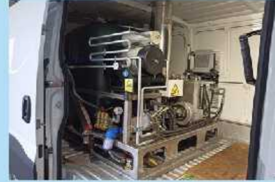
Compresor de paletas con motor hidráulico con enfriador, ubicado en la parte central para un reparto espacial inmejorable de todos los componentes
