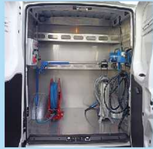
Estantes porta-accesorios en Inox AISI 304 como todos los acabados del equipamiento
