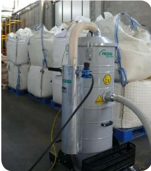
Los aspiradores industriales en versión ATEX pueden utilizarse en zonas con presencia de polvos o gases potencialmente explosivos. RGS produce una amplia gama de aspiradores aptos para ambientes clasificados zona 22 o 2 (3D-3G-3GD), diseña a medida aspiradores aptos para operar en zona 21 (2D)
