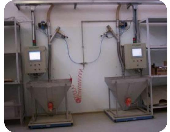
SISTEMA DE TRANSPORTE NEUMÁTICO DE MATERIALES FRÁGILES EN EMBALADORAS
