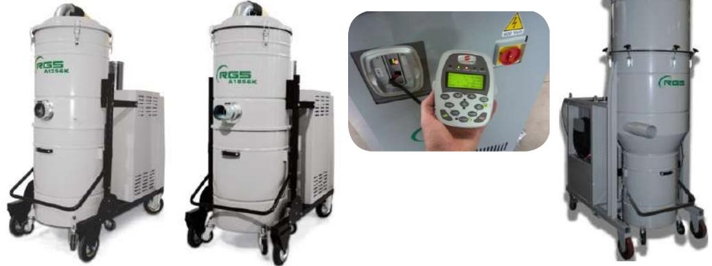
Estos aspiradores industriales pueden estar equipados con filtros de cartuchos y convertidores en el grupo aspirante. El inversor controla los parámetros de trabajo (nivel de vacío, posibles consentimientos externos) y optimiza el consumo de energía variando los parámetros de rotación del motor y preservando de posibles absorciones anormales.
